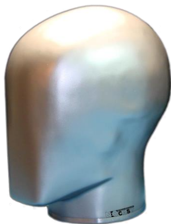
Rys. 1. Makieta głowy typu 625 wykonana ze stopu magnezu wraz z podstawą mocującą czujnik typu 7265A
